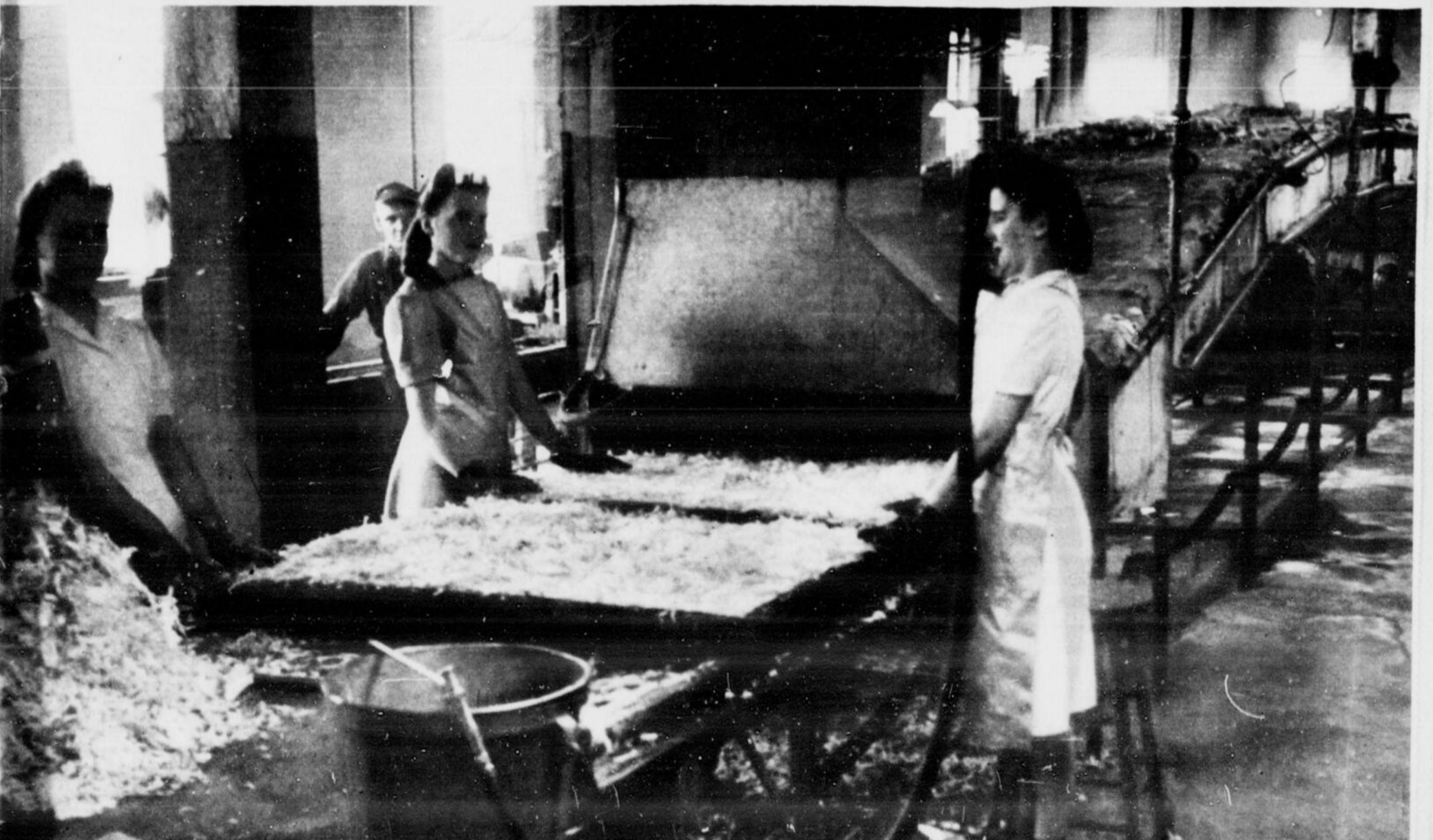
La principale opération de la déshydratation est sûrement celle qui consiste à faire passer les lamelles ou les petits cubes de choux, carottes et navets, dans un long four. Les légumes y circulent sans cesse sur des claies fixées à des chariots. Quand les légumes sortent du four, ils sont déshydratés. (Suite à la 6e page)
