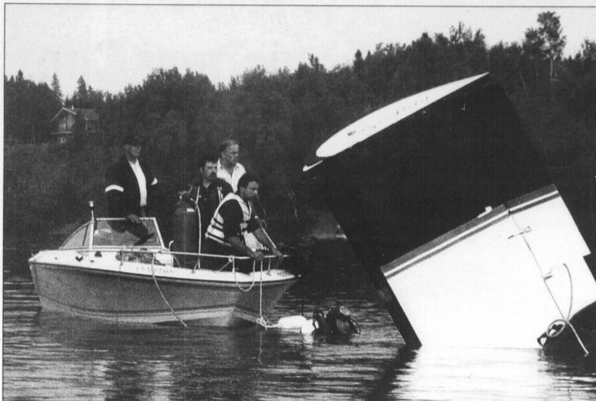
PLONGEURS - Tout au long de la journée, les plongeurs ont travaillé fort afin d'installer les ballons utilisés pour ramener la carlingue à la surface. (Photo Steeve Tremblay)
