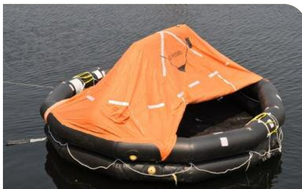
Démonstration d'un déploiement d'un radeau de sauvetage pouvant contenir 25 personnes.
