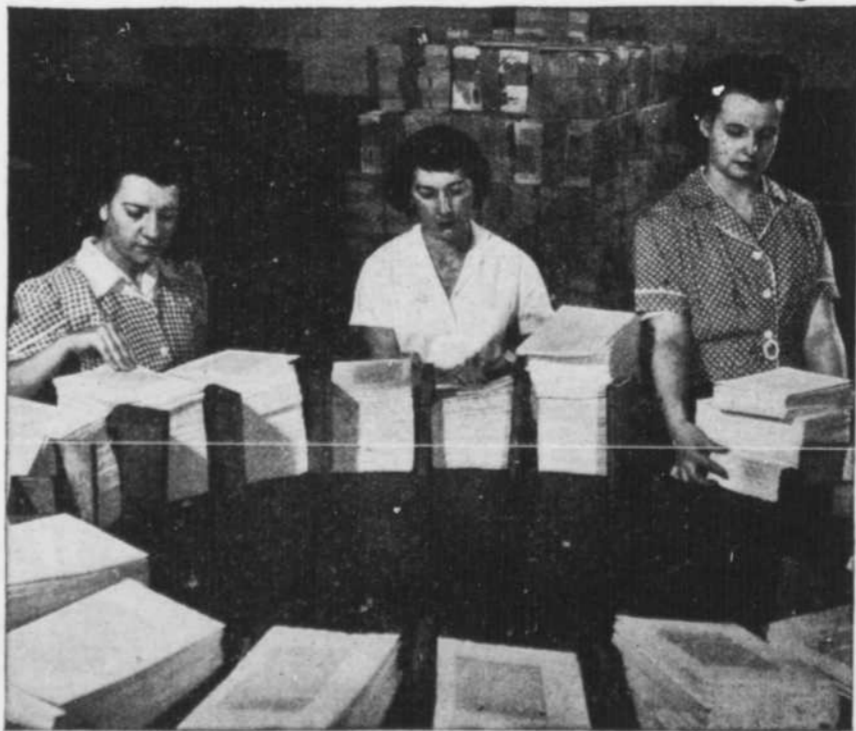
Dans les grandes maisons d'édition, on recourt à une grande table rotative pour classer les sections; celles-ci passent ensuite à la couture.
