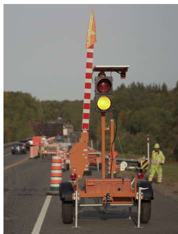
Barrière de contrôle de la circulation pour travaux sur support mobile
