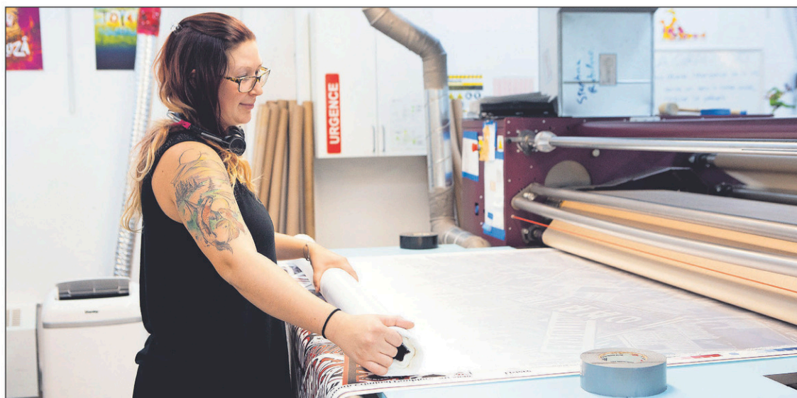
Ici, la technicienne en produits textiles, Eugénie Gagnier, veille au transfert d'un imprimé sur du polyester grâce au procédé de sublimation.
