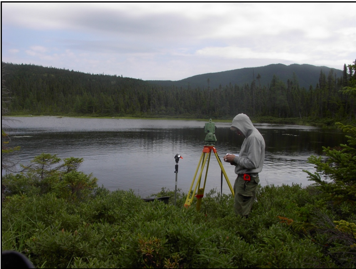
Figure 13 : Levé bathymétrique à l'aide d'une station totale.
