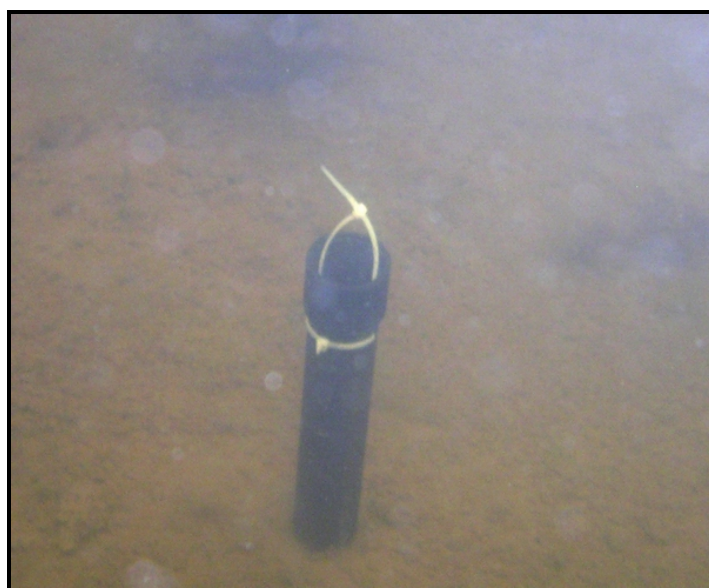
Figure 11 : Système d'ancrage du capteur de pression submersible
