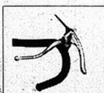
Leviers des freins accessibles à deux endroits pour votre protection
