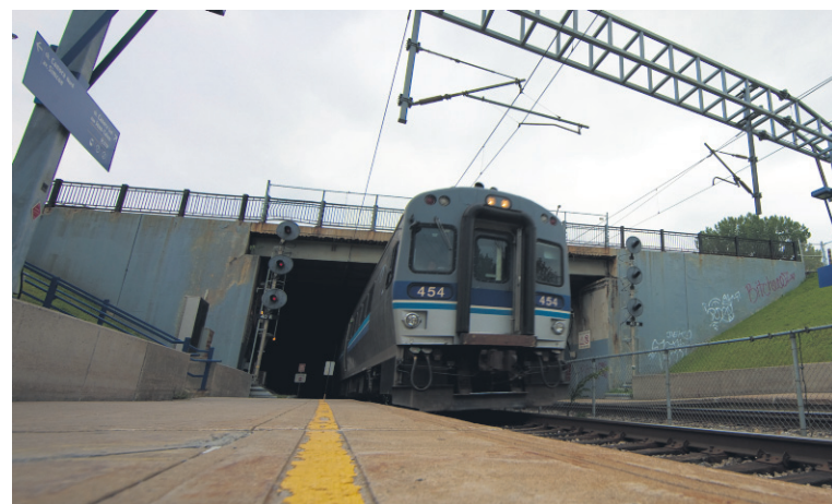
PHOTO ANDRÉ PICHETTE, LA PRESSE Sans sortie de secours, les passagers coincés dans un train en feu au milieu du tunnel du mont Royal seraient obligés de marcher 2,5 km pour arriver à l'air libre.
