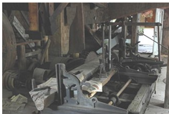
« carriage » pour transporter le bois vers la scie ronde.
