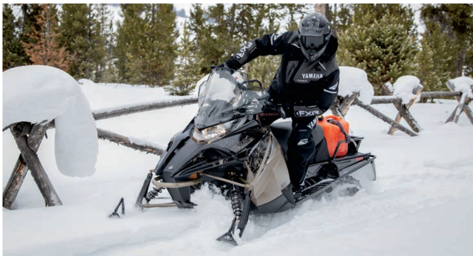
La Transporter 800, de Yamaha (Norseman X chez Arctic Cat), fait concurrence dans le segment sport-utilitaire, où son puissant bicylindre deux temps à injection semi-directe de 794 cc et sa chenille imposante de 15 x 153 x 2,25 po (38 x 389 x 5,7 cm) livrent le niveau de performance recherché par les adeptes de ce créneau.
