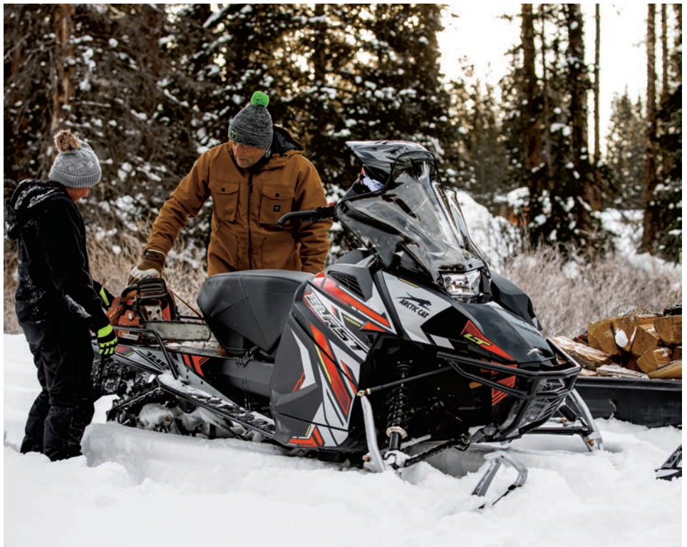
La Blast LT d'Arctic Cat (ainsi que sa consœur Transporter Lite, chez Yamaha) est propulsée par un monocylindre deux-temps de 397 cc refroidi au liquide et alimenté par injection semi-directe. À la fois simple et sophistiqué, celui-ci est léger et d'une douceur surprenante.
