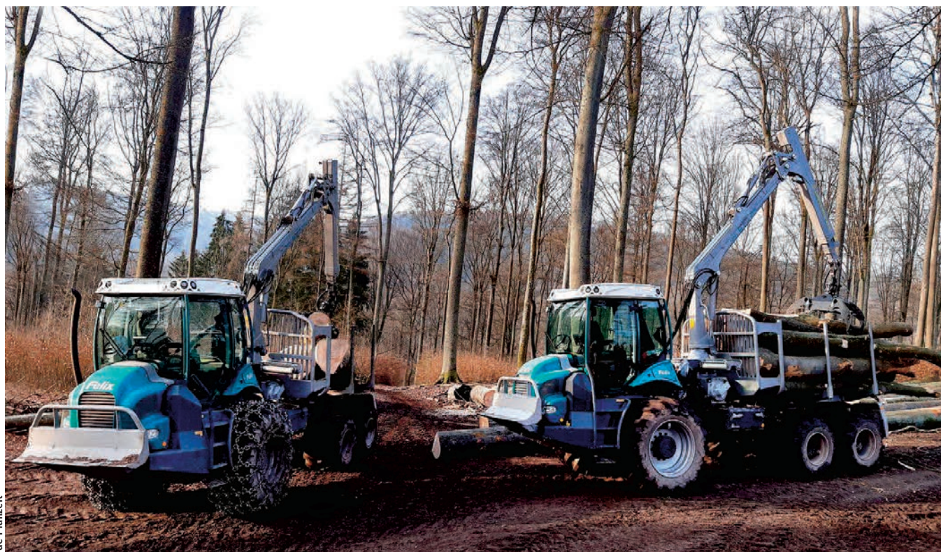
Le Felix à 6 roues s'utilise comme châssis court pour le bois long, comme châssis combiné avec l'arrière télescopique pour le bois court et long, et comme châssis long pour le transport.
