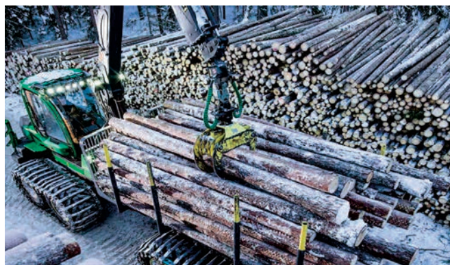
Le 1010G de 12 tonnes est construit avec un empattement plus court qui facilite les manœuvres en terrain irrégulier sans compromettre le volume de chargement.
