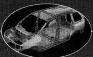
Structure avec renforcements en « triple H »
