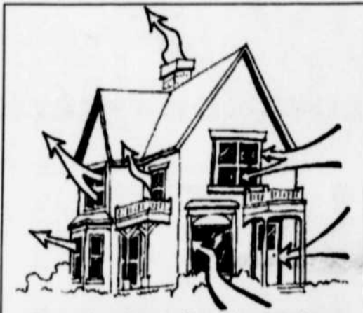
Une maison bien isolée et bien étanche est plus facile et moins onéreuse à climatiser.
