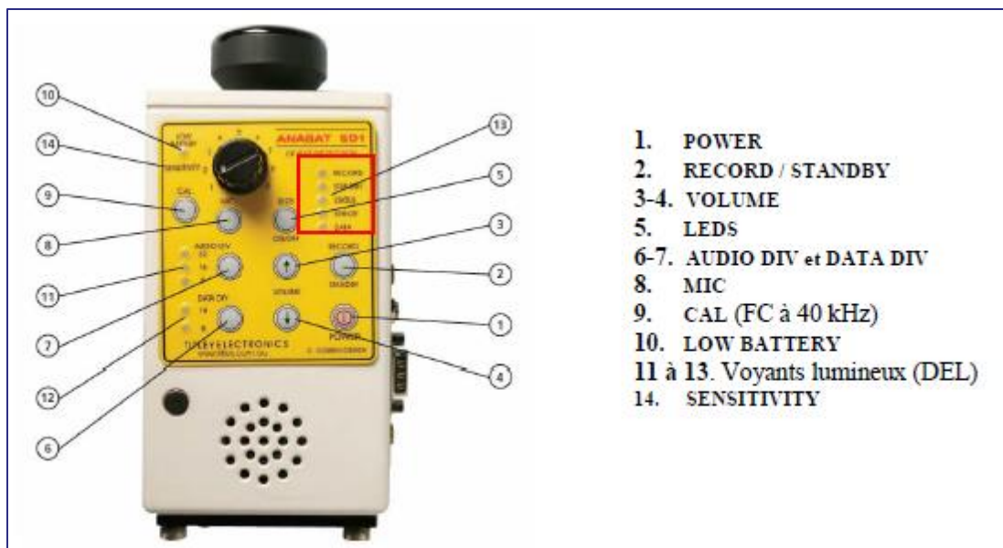
Figure 5. Détecteur Anabat SD1, vue de face et identification de ses composants (le système SD2 est très similaire)
