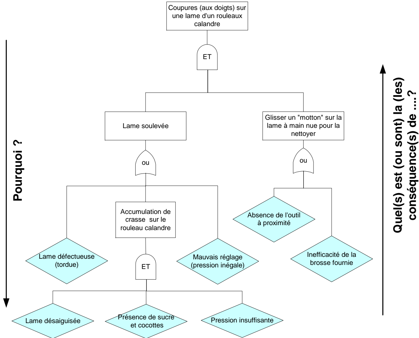
Figure 11 : exemple d'arbre des fautes "Coupures sur les lames des rouleaux des calandres"
