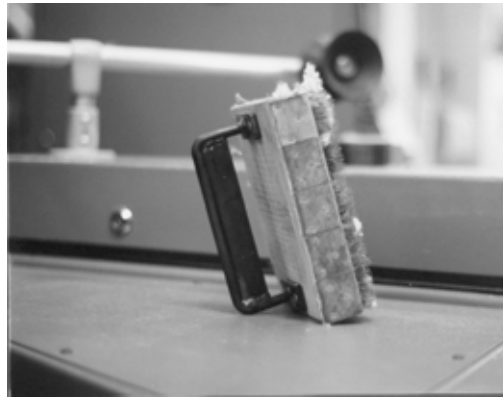
La brosse étroite servant à nettoyer la garniture du « doffer » est faite maison. Il en existe aussi une longue.
