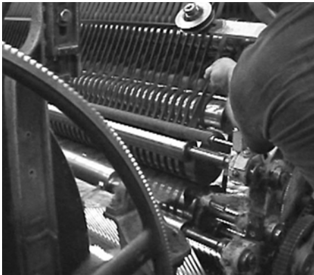
Le séparateur est nettoyé à l'aide du jet d'air.
