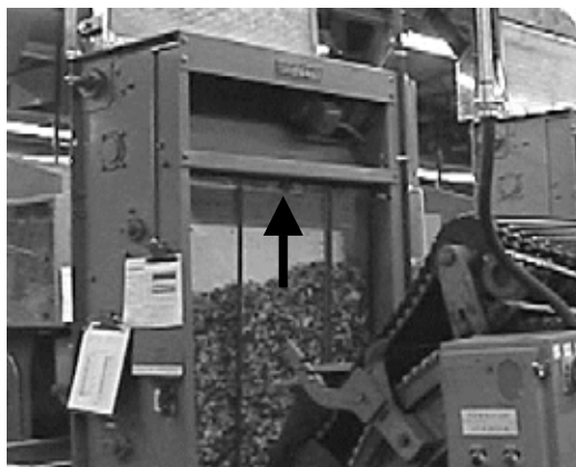
La vis papillon est située dans la partie supérieure de la fenêtre, au centre de la chute.
