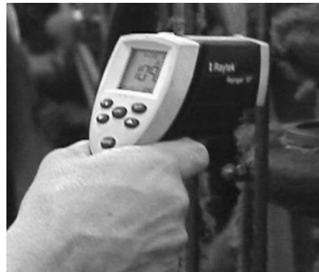
Le détecteur de chaleur à distance permet de quantifier les mesures de chaleur radiante.
