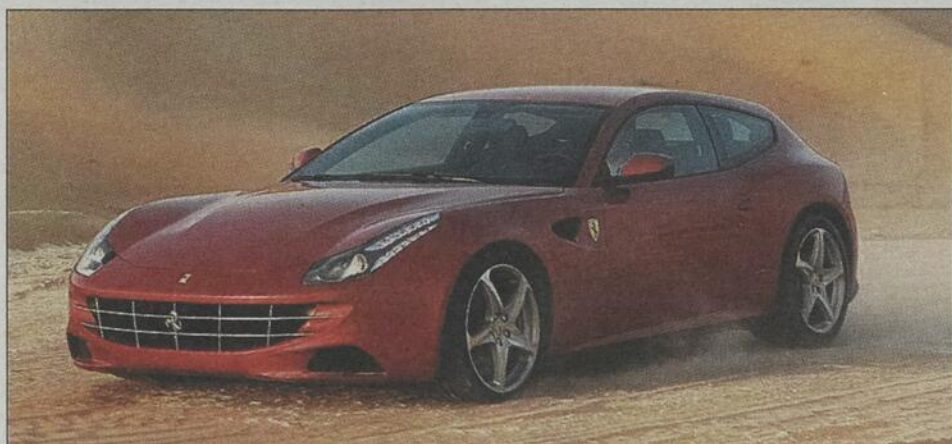
La Ferrari FF 2012 est un acronyme de «Ferrari Four» pour quatre places et quatre roues motrices. Son nouveau moteur V12 de 6,2 litres développera 660 chevaux à 8000 tr/min.
