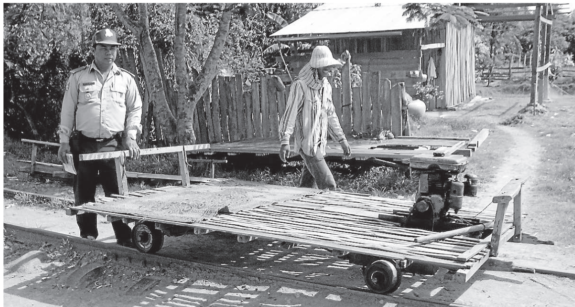
Le train de bambou consiste en une plateforme de bois sur des roues. Il est propulsé par un petit moteur à bateau.
