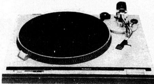
SL-B2 TOURNE-DISQUE semi-automatique à entraînement par courroie. Moteur c.c. asservi par générateur de fréquence. Auto-retour du bras et auto-arrêt. Vibration à basse fréquence: -70dB (DIN B). Pleurage/scintillement: 0,045% eff. pondéré. Plateau de 30,4cm (12") en aluminium moulé. Repères stroboscopiques éclairés. Levier d'attente ultra-souple.
