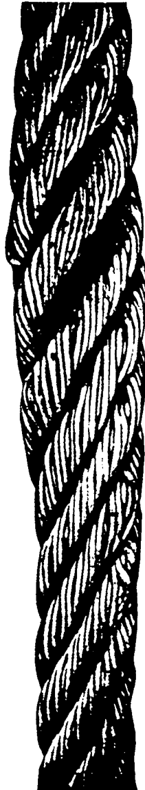
Écrasement localisé du câble.
