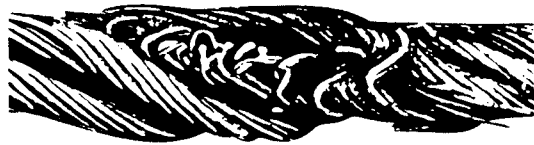
Câble coincé après avoir déraillé d'une poulie.
