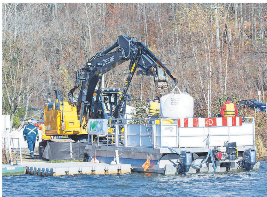
174 tonnes de Phoslock avaient été déversées dans le lac Bromont à l'automne 2017 dans le cadre de projet-pilote visant à éradiquer le phosphore dans le lac, un agent qui contribue grandement à la prolifération des algues bleu-vert. (Photo : Journal Le Guide – archives)
