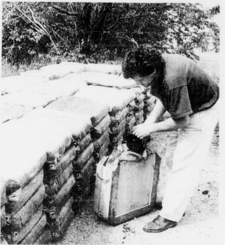
SYSTÈME BREVETÉ - Un nouveau système utilisant des sacs de terre est testé ces jours-ci devant le pavillon Sagamie. Gilles Pitre s'affaire à remplir un des sacs. (Photo Sylvain Dufour)
