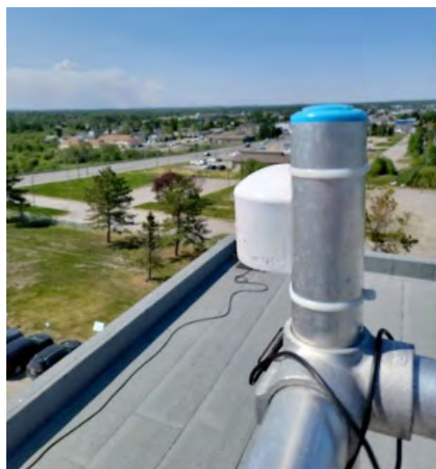
Figure 5 : Exemple de capteur déployé à La Sarre (Abitibi-Témiscamingue) pendant l'été 2023 pour mieux suivre la qualité de l'air en lien avec les feux de forêt
