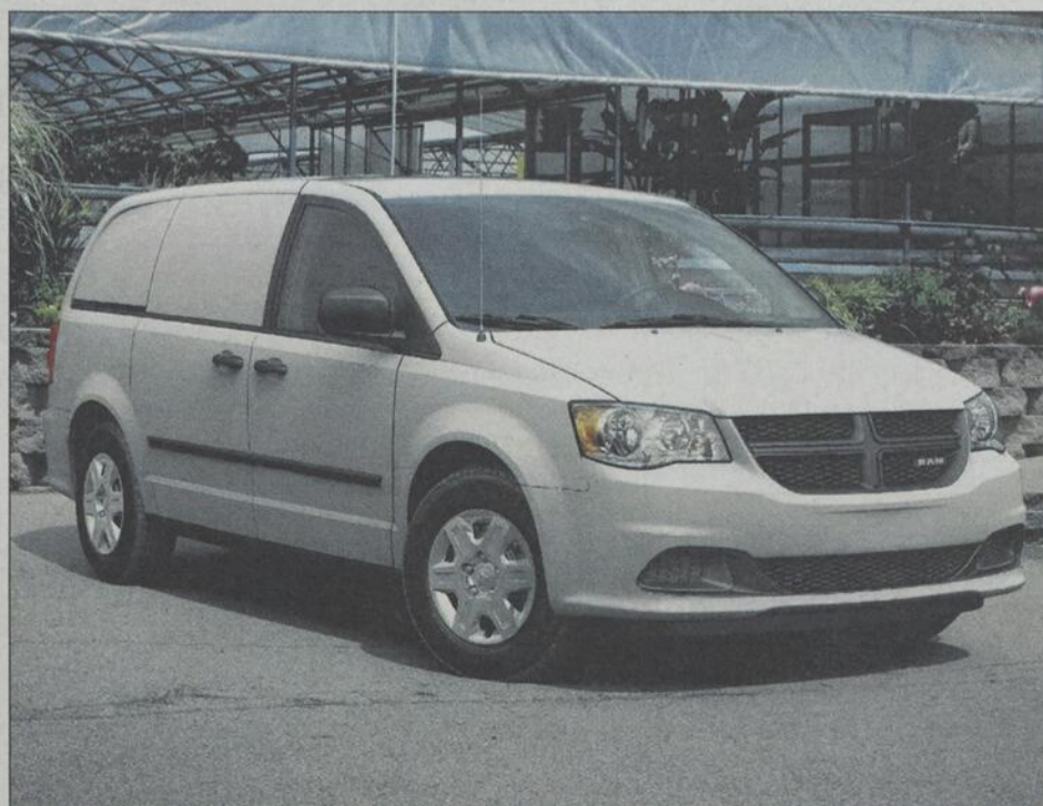
La Ram Cargo Van est mue par un V6 de 3,6 l (283 ch). La charge utile maximale est de 818 kg et la capacité de remorquage atteint 1633 kg.
