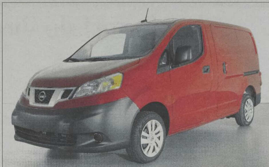
La Nissan NV200 peut transporter une charge de 680 kg dans sa soute. Le moteur de série est un L4 de 2,0 l (131 ch).
