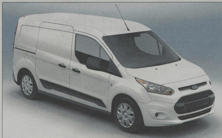
La Ford Transit Connect peut être animée par un L4 de 2,5 l (169 ch) ou un L4 turbo de 1,6 l (178 ch). La charge utile est de 780 kg et la capacité de remorquage est de 907 kg.
