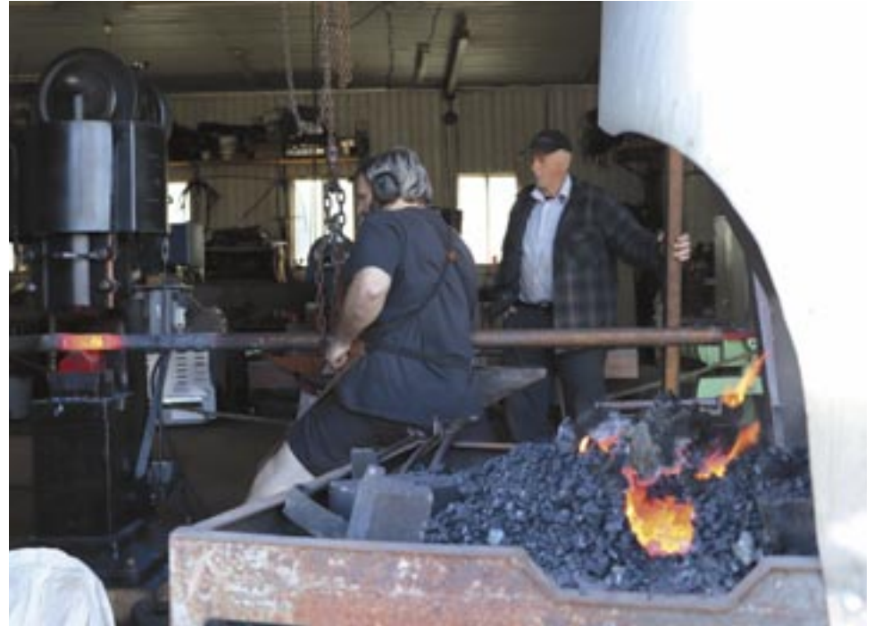
François chauffe sa pièce dans son feu de forge pour ensuite le façonner avec son marteau pilon. PHOTO BÉLINDA DUFOUR
