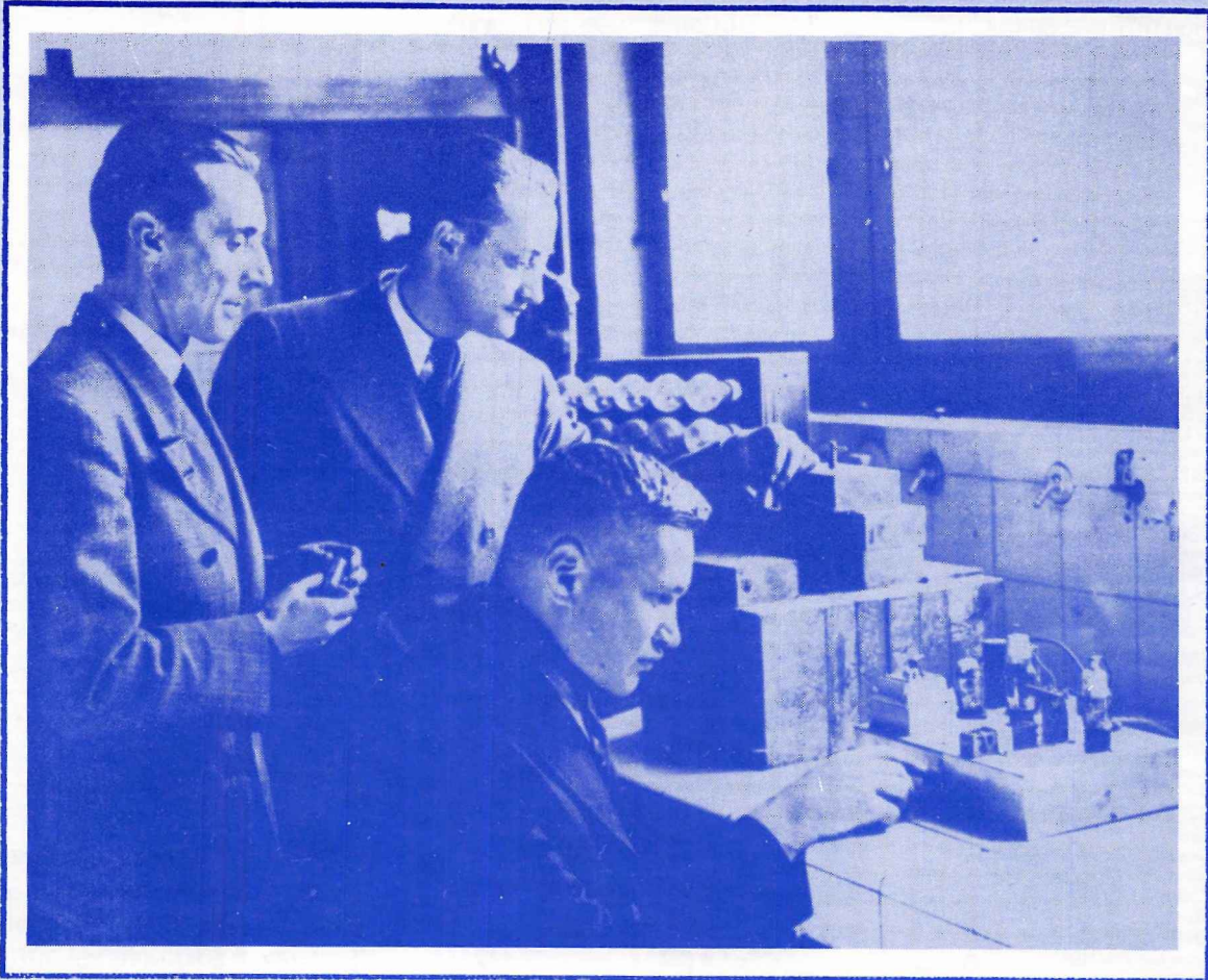
Fig. 6. Frédéric Joliot, Hans Halban et Lew Kowarski dans le laboratoire du Collège de France. Joliot tient un compteur Geiger-Müller dans ses mains, Kowarski règle un appareil, Halban attend afin d'introduire un détecteur prêt pour une mesure radioactive autour d'un compteur G.-M., à l'intérieur d'un château formé de briques de plomb. Pour mesurer la densité des neutrons lents dans une cuve contenant de l'eau lourde, ils employaient des détecteurs en dysprosium. Le dysprosium devient radioactif avec une période voisine de 150 minutes, par la capture des neutrons, avec une section efficace \sigma proportionnelle à 1/v , v = vitesse des neutrons. Mars-avril 1940, reconstitué en 1947 avec, comme acteurs, les personnes mêmes, pour le tournage de La Bataille de l'Eau lourde , film de Jean Marin et de Jean Dréville.
