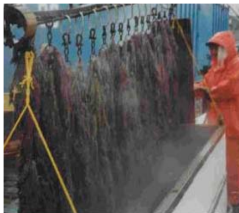
Figure 2. Drague faubert utilisée pour le contrôle des étoiles de mer.
