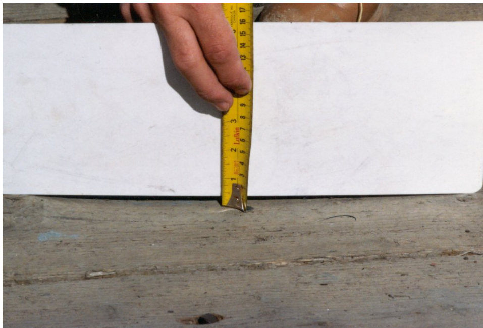
Photo 4.6-2 a) Usure légère d'un platelage en bois
