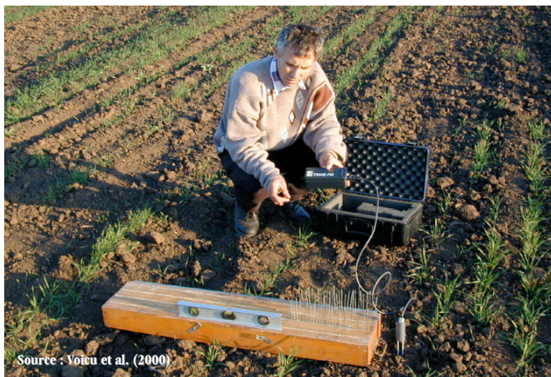
Figure 8. Exemples de deux modèles de profilomètre à aiguilles utilisés pour mesurer la rugosité de surface : a) profil linéaire mesuré sous couvert végétal (gracieuoseté de Jalal Khaldoune, étudiant au doctorat, INRS-ETE); b) profil de surface mesuré sous condition de sol nu.
