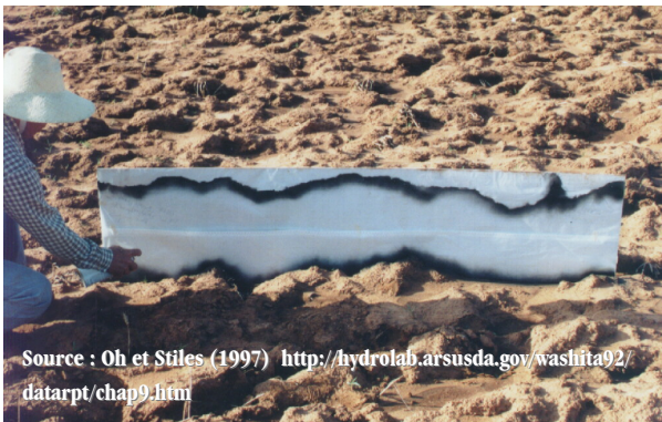
Figure 7. Exemple d'utilisation d'un panneau rigide quadrillé et d'un contenant de peinture en aérosol pour marquer et mesurer le profil de rugosité de surface d'un sol nu.
