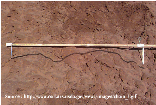
Figure 6. Exemple d'utilisation de la méthode de la chaîne avec une règle-vernier.
