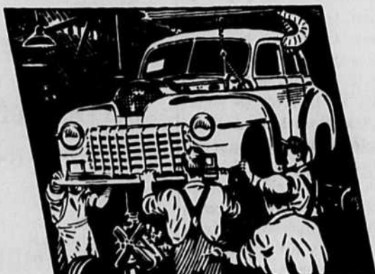
Les caisses sont baissées avec soin sur le châssis et sont solidement fixées. Les lignes de production sont synchronisées de manière à éviter tous les délais possibles.
