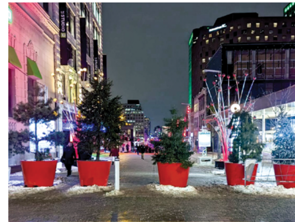
Dispositif antibélier conçu de manière à préserver une esthétique hivernale cohérente avec la saison Rue Sainte-Catherine Ouest Montréal, décembre 2025
