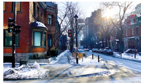
Saillies réduisant la largeur du passage à traverser à l'intersection et bateaux pavés défractionnés
