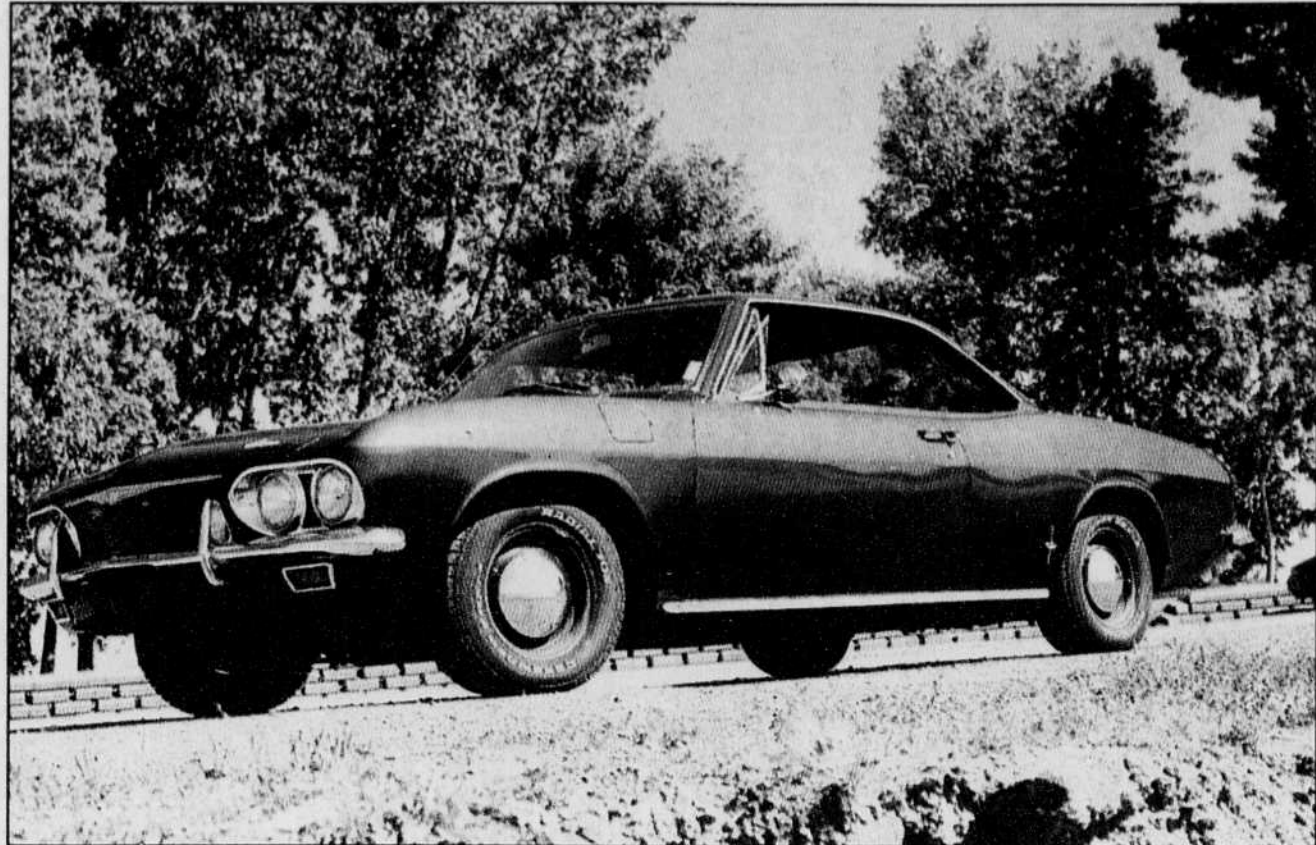
Comme la Porsche, le moteur de la Corvaire est refroidi à l'air.
