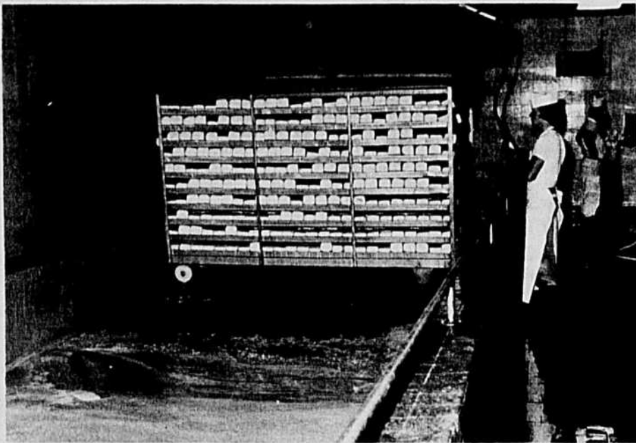
On retire du bain de saumure le fromage qui y a séjourné pendant 12 à 24 heures.
