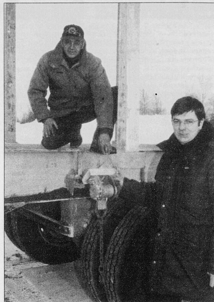
INNOVATIONS - Paul Bouchard, sur la remorque, pointe l'endroit où on a éliminé les soudures alors que Richard Tremblay montre le nouveau treuil en aluminium.
