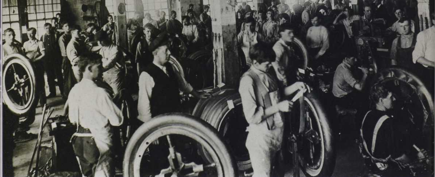
1924. Les pneus étaient entièrement faits à la main avec le même procédé que celui employé pour confectionner les souliers.
