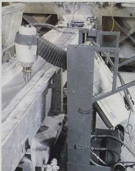
Un appareil capable de détecter en moins d'une minute les moindres saletés présentes dans l'aluminium liquide.
