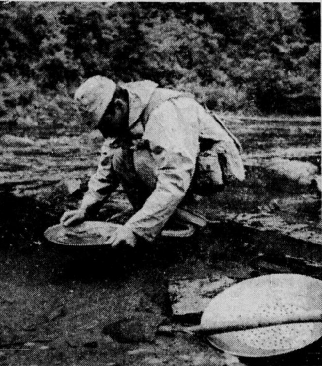
Bill Warren utilise la vieille méthode des chercheurs d'or qui consiste à brasser les sables aurifères à la batée.
