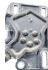
Vue avant du port de charge J1772.
