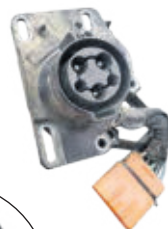
Vue avant du port de charge J1772.
