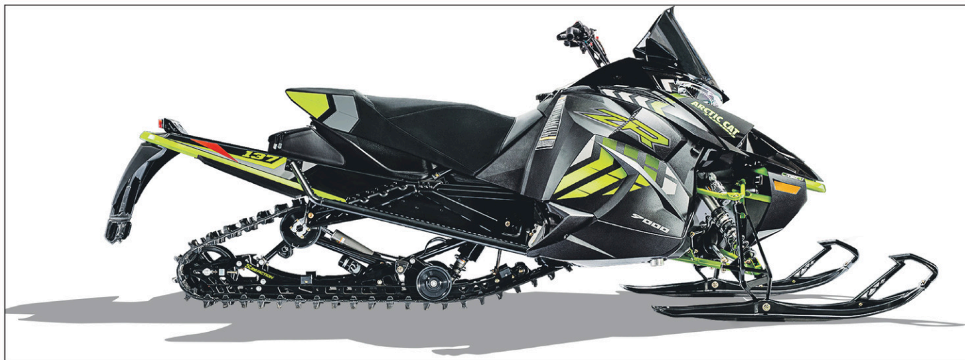
La ZR 9000 règne au sommet de la gamme d'Arctic Cat avec son nouveau moteur turbo à trois cylindres et quatre temps de 998 cm 3 et 180 ch.
