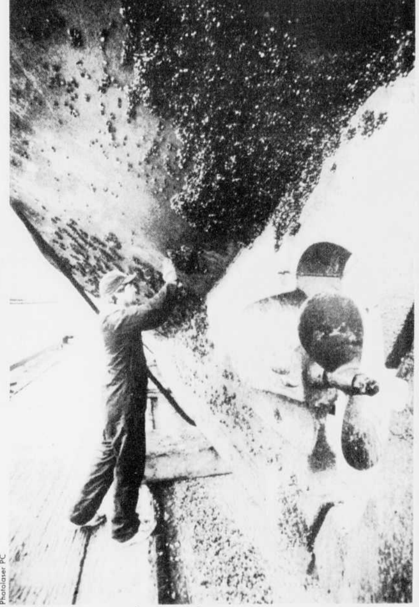
Mollusques indésirables Un ouvrier examine des mollusques zébrés, fixés à la coque d'un navire qui a été sorti de l'eau, à Toronto, tout exprès pour enlever ces passagers indésirables, qui infestent les Grands-Lacs depuis peu. C'est probablement de l'eau des ballasts d'un navire étranger que proviennent les premiers spécimens.
