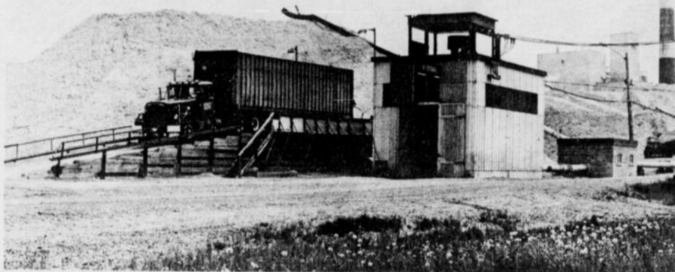
Ces énormes tas de copeaux, fournis par 12 scieries de la région, sont progressivement acheminés vers le "lessiveur continu" Kamy. Ce lessiveur a une hauteur de 190 pieds et un diamètre de 11.
