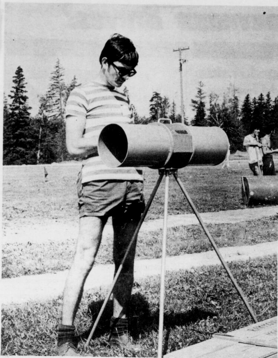
Non, ce n'est pas une machine à pluie. Il s'agit d'un instrument qui sert à vérifier la vitesse du vent et que l'on surnomme anémomètre. Il ne faut pas que la vitesse du vent soit trop forte pour qu'un record soit homologué.
