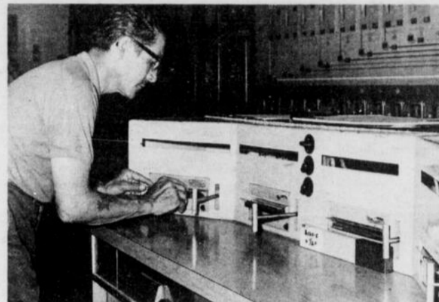
M. Georges-Henri Côté insère la carte dans l'ordinateur qui commandera toutes les manoeuvres, entièrement automatisées, mélangeant de façon efficace les différentes pâtes employées par la compagnie Price.
