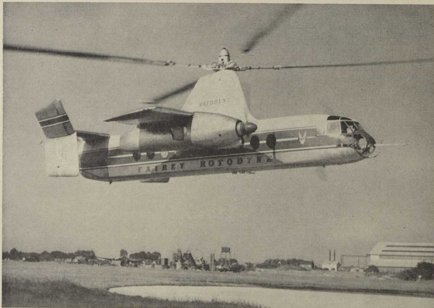
LE ROTOR, DE 90 PIEDS DE DIAMETRE, DONNE AU "ROTODYNE" LES AVANTAGES DE L'HELICOPTERE. SES DEUX MOTEURS DE 3,500 hp LUI ASSURENT UNE AUTONOMIE DE 450 MILLES, A 185 MILLES A L'HEURE.
