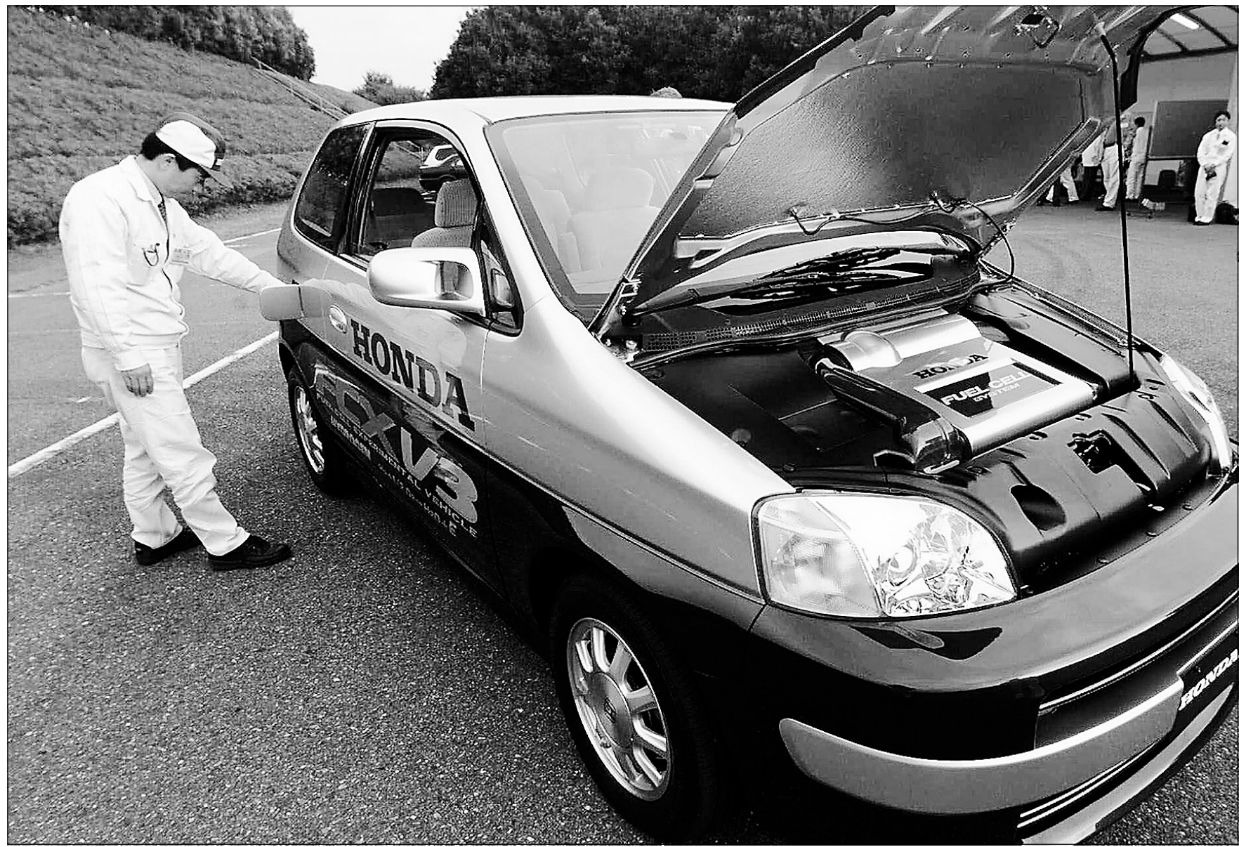
La Honda FCX-V3 fonctionnant avec une pile à combustible. Ballard prévoit être le principal fournisseur de piles à combustible pour des centaines de véhicules à l'hydrogène qui seront mis à l'essai ces prochaines années au Europe, en Amérique du Nord et au Japon.
