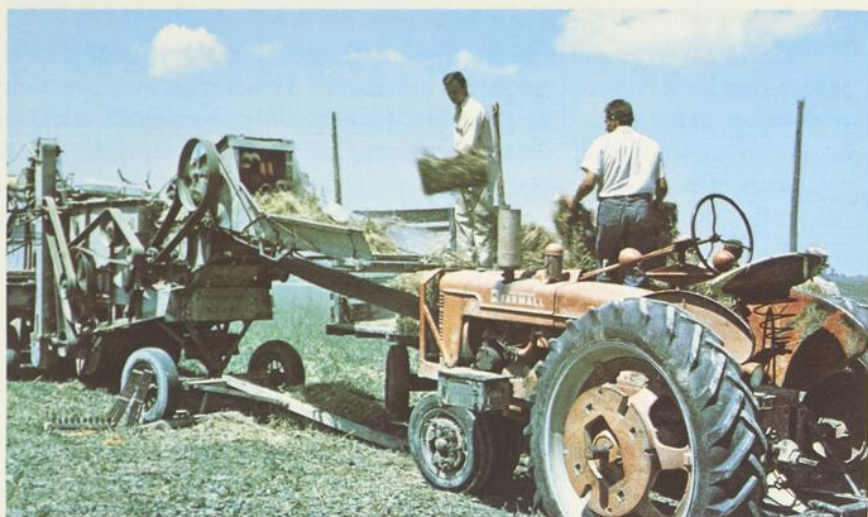
Une batteuse ordinaire qui bat du lin pressé
