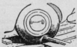
RAILS DE CHEMIN DE FER qui causent souvent des meurtrissures ou des ruptures de pneus
