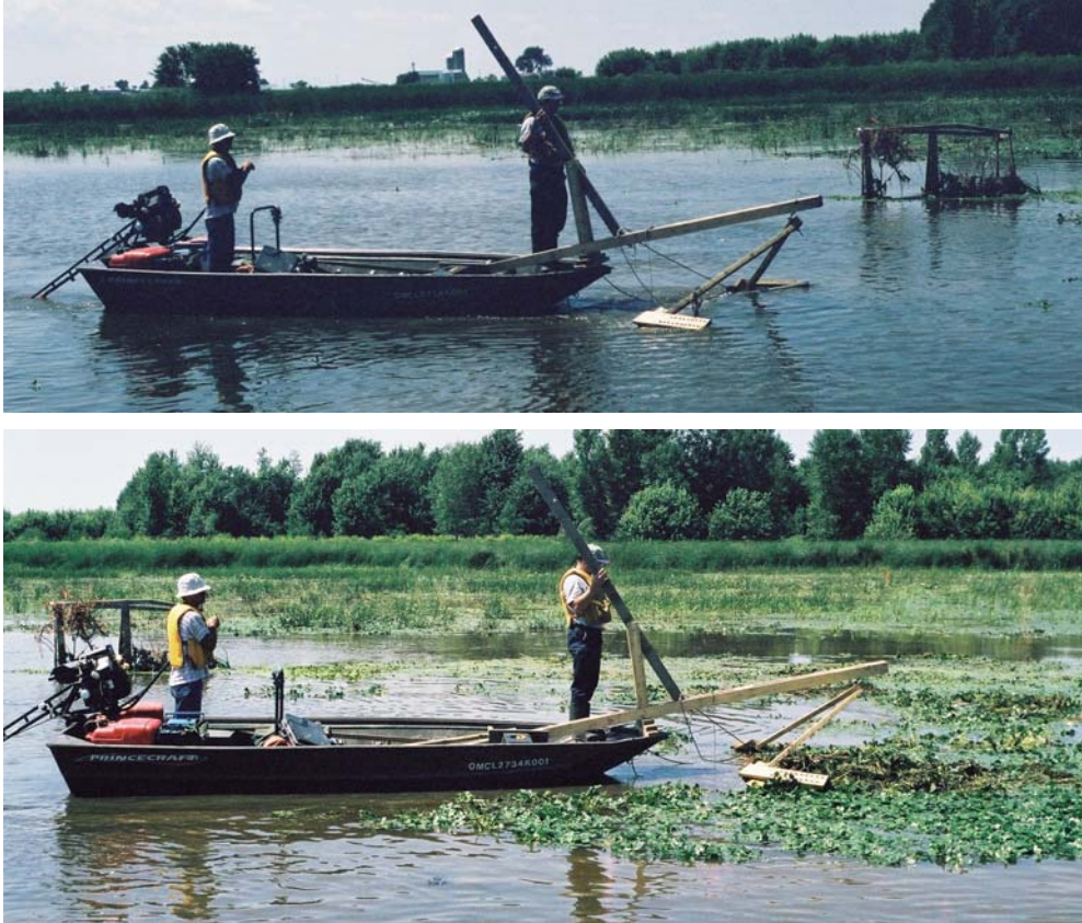
Figure 20. Râteau de bois fixé à l'avant de la chaloupe.
