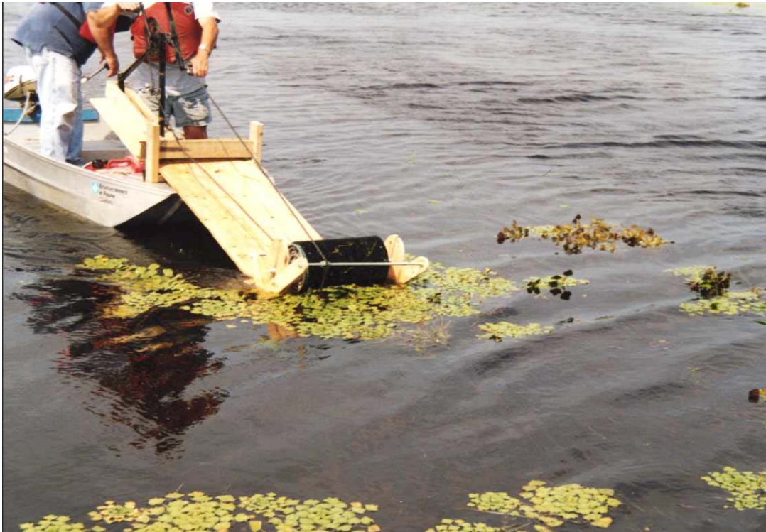
Figure 18. Prototype de méthode de récolte à l'aide de rouleaux de caoutchouc.
