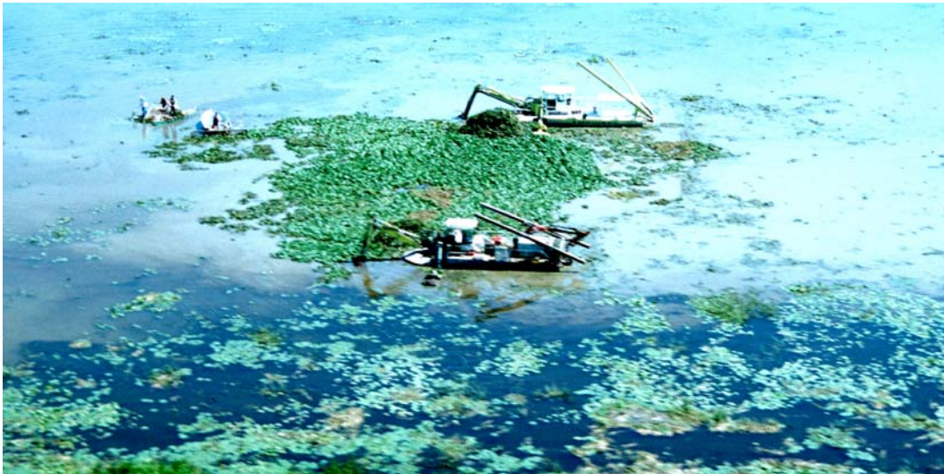
Figure 23. Récolte de châtaigne d'eau à l'aide de câbles reliant les deux excavatrices amphibies.
