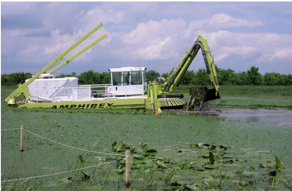
Figure 22. Amphibex récoltant la châtaigne d'eau à l'aide d'un râteau.
