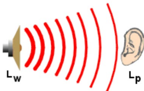
Figure A-10 Niveau de puissance acoustique ( L_w ) d'une source de bruit et niveau de pression acoustique ( L_p )
