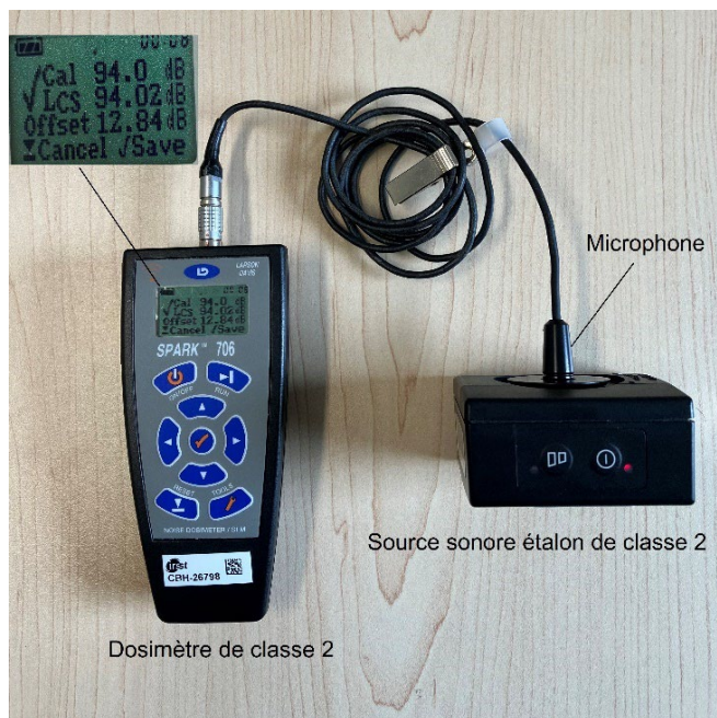
Figure 23 Dosimètre Larson Davis Spark 706 avec source sonore d'étalonnage branchée au microphone
