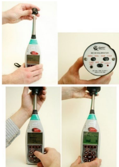
Figure 22 Sonomètre avec source sonore d'étalonnage branchée au microphone
