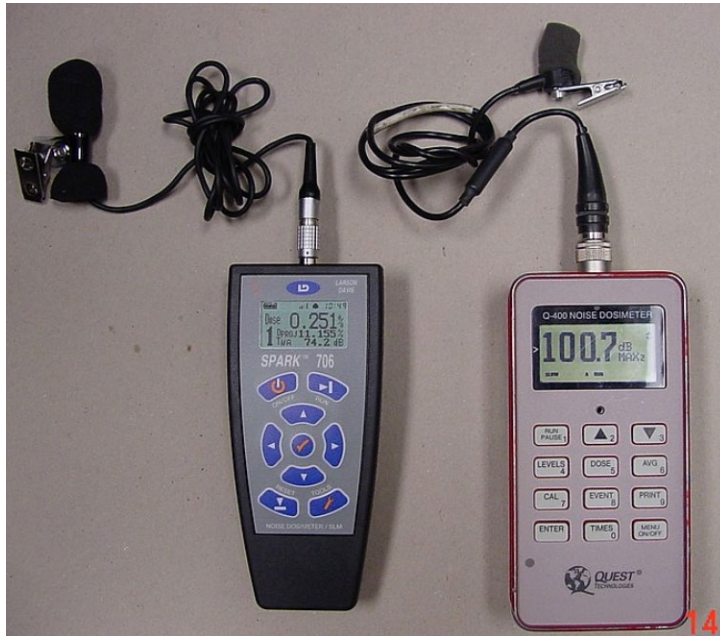
Figure 16 Dosimètres avec le fil lié au microphone - Modèles Spark 706RC de Larson Davis et Quest Q-400 de TSI
