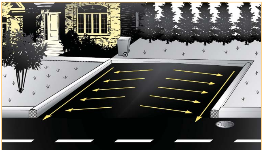
Figure 2 Drainage d'un stationnement résidentiel double
