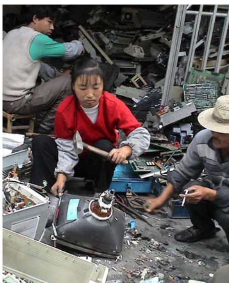
Destruction du tube de rayon cathodique d'un moniteur en vue d'extraire le cuivre de l'entonnoir. 2001. © Basel Action Network
