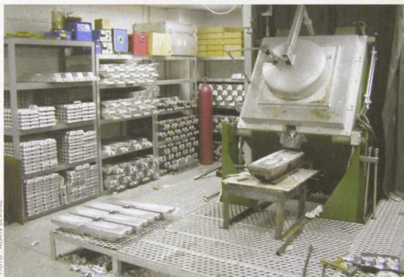
Dans le laboratoire de Fawzy Hosny Samuel, ce four permet de former et de couler des alliages d'aluminium en lingots afin d'étudier leurs propriétés.
